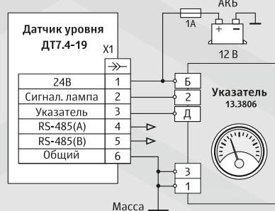
Схема подключения датчика модификации 19
